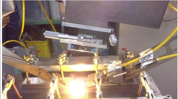
Imagen 1. Comparación de las salpicaduras durante la soldadura por láser de fibra en imágenes
