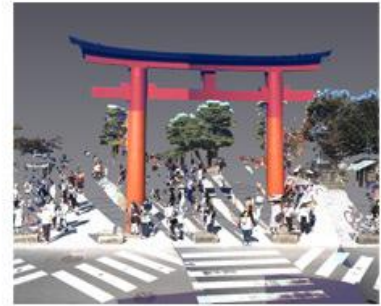
Nube de puntos 3D creada a partir de los datos obtenidos por MMS
