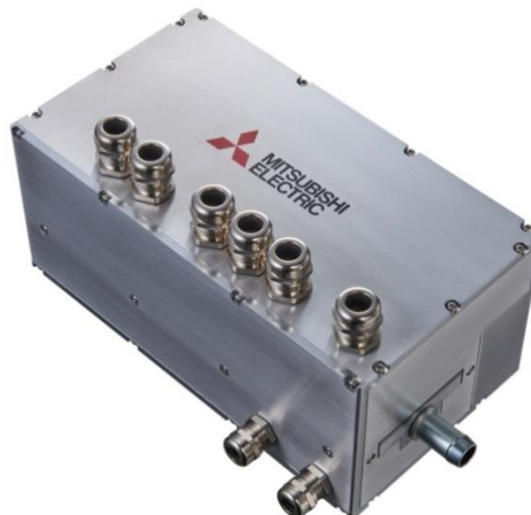
Inversor SiC ultracompacto (modelo de trabajo)
