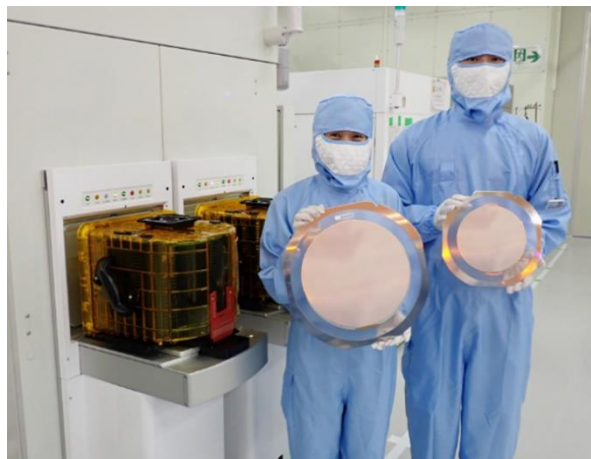
Oblea de silicio de 12 pulgadas y equipo de medición de resistencia que se muestran como referencia junto con una oblea de 8 pulgadas (derecha)
