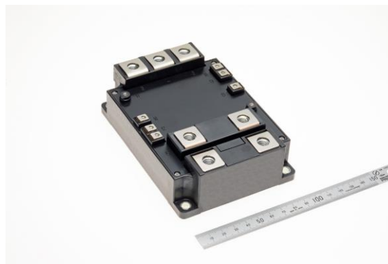
Módulo IGBT tipo LV100 de 1,2 kV para uso industrial (CM1800DW-24ME)
