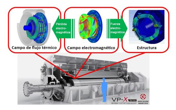
La tecnología analiza la interacción entre el campo electromagnético y el campo de flujo de termofluido, así como las configuraciones estructurales de los generadores eléctricos. De esta forma, es posible calcular al detalle la distribución de la temperatura y la vibración basándose en la distribución detallada de las pérdidas y la fuerza electromagnética.
