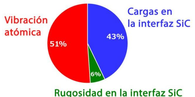
Fig.2 Impactos de los factores que limitan la resistencia en la interfaz SiC
