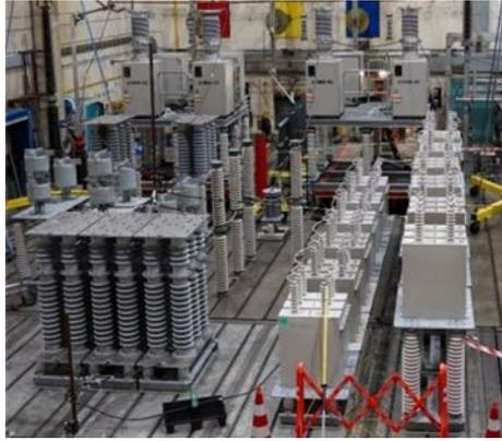
Prototipo de disyuntor mecánico de CC de 160 kV utilizado en las pruebas
