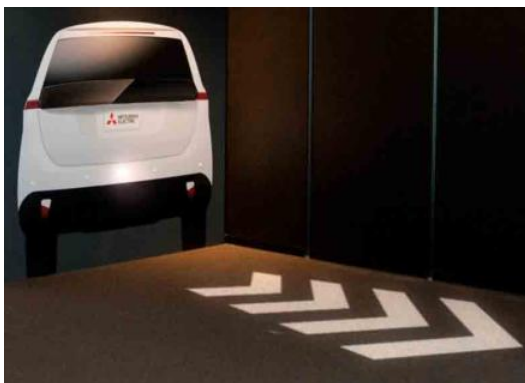
Indicador de marcha atrás con señales luminosas en la carretera
