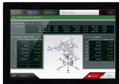
Módulo TFT-LCD a color AA104SL02DDE11 de Mitsubishi Electric con panel táctil capacitivo proyectado
