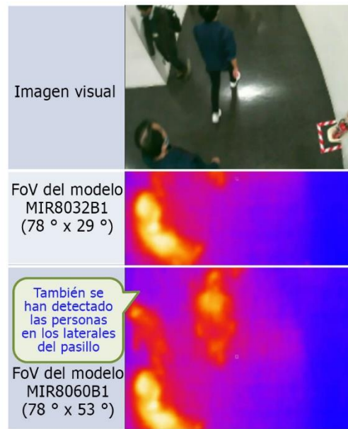
Imágenes visuales y térmicas desde el lateral de la sala (personas caminando por pasillo)
