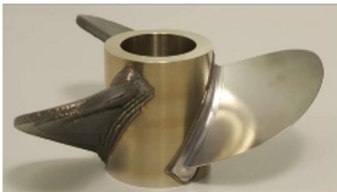
Ejemplo de hélice de 300 mm de diámetro para una embarcación, que consigue reducir el tiempo de procesamiento y los residuos de material en un 80 %
