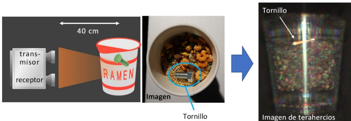
Resultados de la prueba de inspección no destructiva (detección de tornillos en un bote de fideos)
